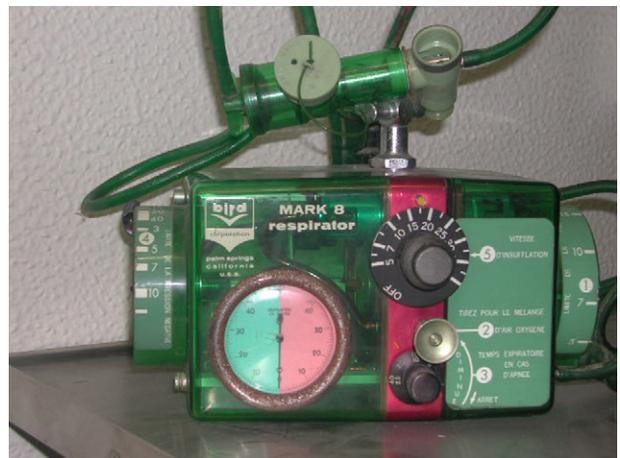
**Figure 7** De toute petite taille, le Bird Mark 8™ a été l'un des premiers ventilateurs barométriques. À débit pré-réglé, initié et cyclé sur la pression, il disposait d'un système de déclenchement de l'insufflation sur l'effort du malade, réalisé par une technologie simple et robuste constituée d'un aimant et d'un mandrin mobile qui ouvrait l'insufflation. (Photographie C. Chopin, association du musée du CHR de Lille).
