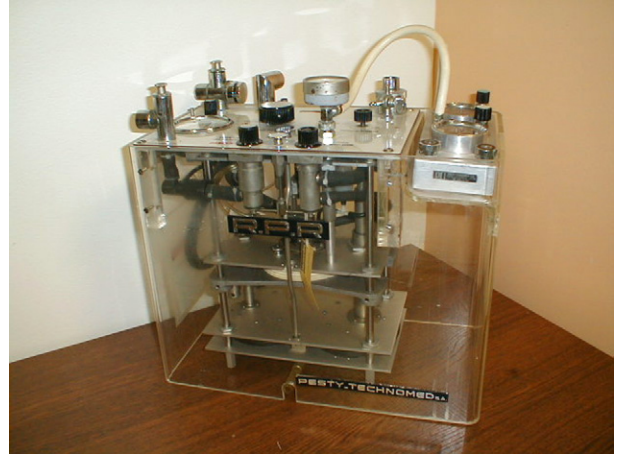
Figure 6 Le RPR™ est le seul appareil véritablement volumétrique. Il fonctionnait à volume pré-réglé cyclé sur le volume uniquement grâce à une logique pneumatique. Il se bloquait si les résistances augmentaient. (Photographie P. Scherpereel, association du musée du CHR de Lille).
