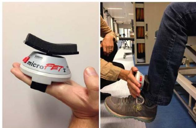
**Fig. 2** Dynamomètre portable de type “handheld”. Exemple de positionnement en vue de la mesure de la force du quadriceps
